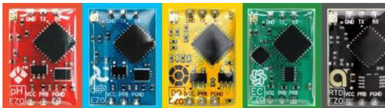
Figura 2. Tarjeta de acondicionamiento de señal EZO para sensores Atlas Scientific
