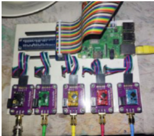
Figura 5. Montaje final de conexiones entre la Raspberry Pi y las placas EZO
